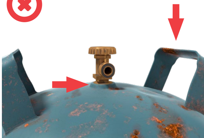
Brak możliwości założenia kołpaka ochronnego na zawór butli i butle tzw. niemki, które nie posiadają tabliczki znamionowej, a wszystkie oznaczenia znajdują się na uchwytach .
